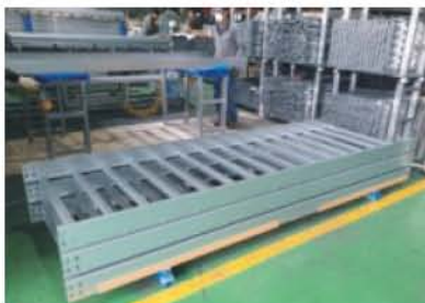
4. 조립 제품 적치 (각목 및 종이각대 보양)
